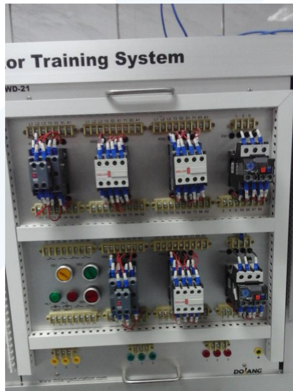
الشكل (11) وحدة كونتاكتورات ومفاتيح وريلميات حرارية
