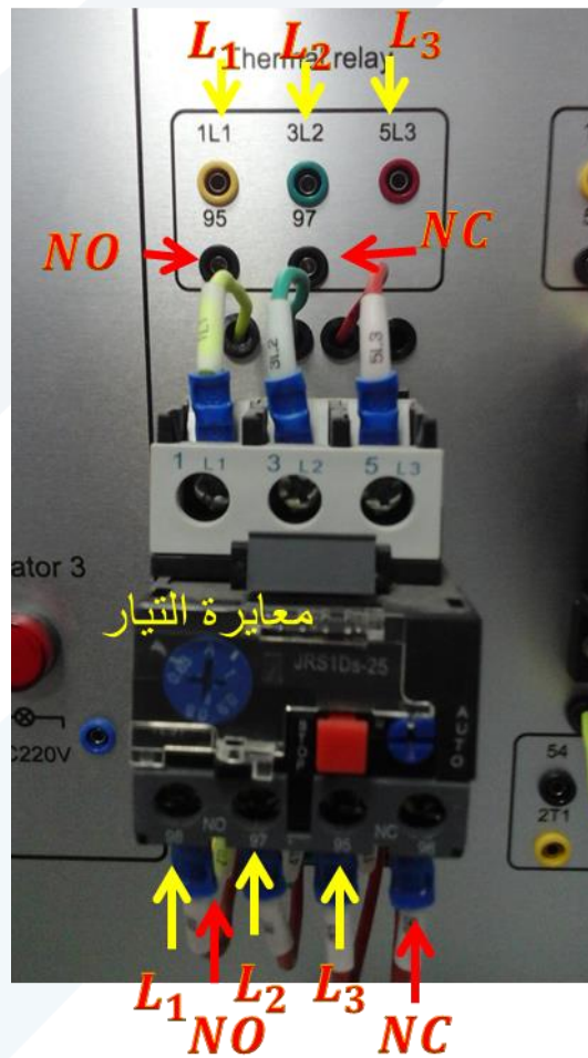
الشكل (8) الريليه الحرارية لفصل التيار الزائد
