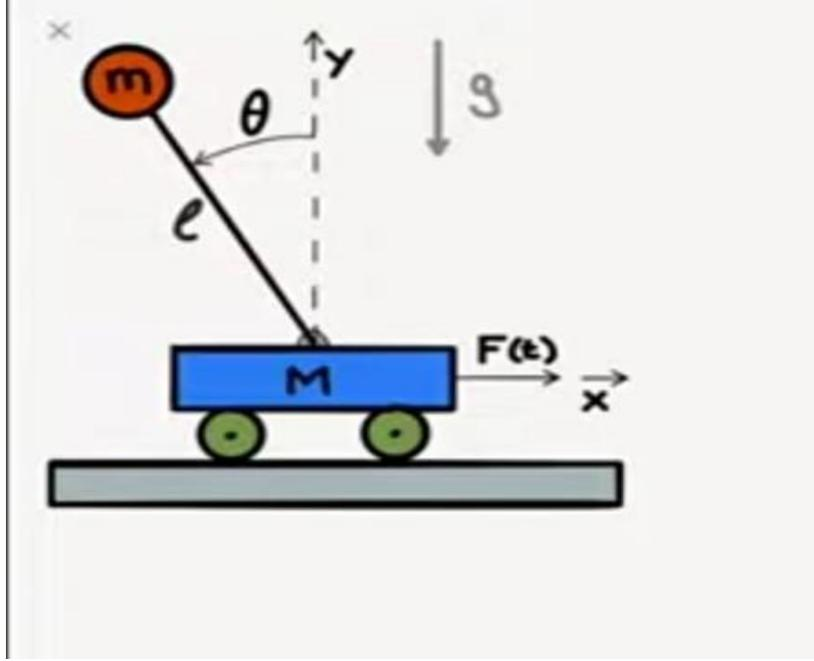
يمثل هذا النظام أفضل اختبار لروبوت التوازن (self balancing robot).
