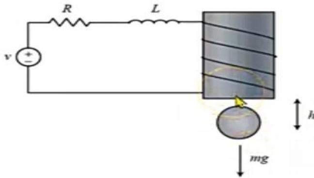
يخضع التيار الكهربائي المار عبر الملف قوة مغناطيسية تستطيع مقاومة قوة الجاذبية وتجعل الكرة (المصنوعة من مادة مغناطيسية) أن تبقى معلقة عند ارتفاع معين مرغوب.
