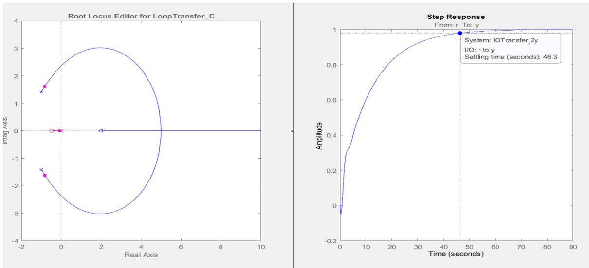
الشكل أعلاه يوضح الاستجابة الزمنية عند قيمة (0.28). حيث وصلت الطائرة بشكل سلس إلى الارتفاع المطلوب ومقدار الانخفاض في البداية أصبح بسيطاً ولكن زمن الاستقرار أصبح أكبر.
