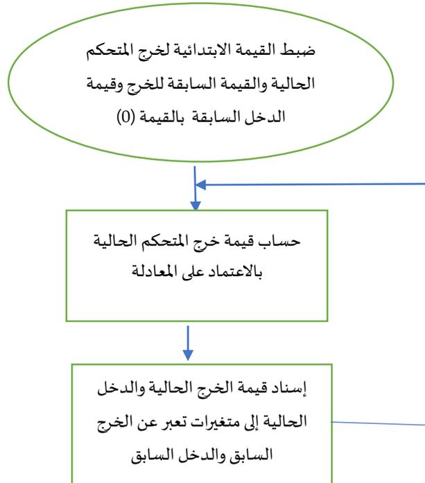
أي عند استخدام التحكم الرقمي لسنا بحاجة إلى استخدام التجهيزات التماثلية . هنا فقط نحول المتحكم إلى المستوي (Z) ونستنتج معادلة الفروق حتى نستطيع منها حساب خرج المتحكم في كل لحظة ثم نزود المعادلة برمجياً ضمن المتحكم المراد استخدامه (pic, plc, Arduino,.....etc).
