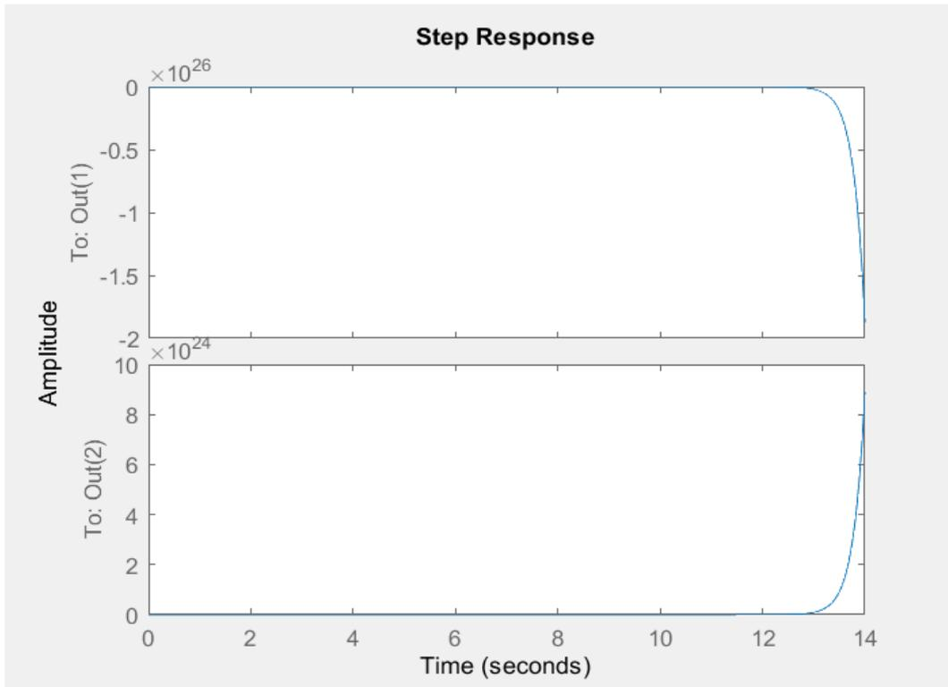
يتضح لدينا من القيم المميزة وجود قيمة مميزة موجبة ستأخذ النظام نحو عدم الاستقرار. وكذلك يتضح عدم الاستقرار من الاستجابة الزمنية للنظام.
