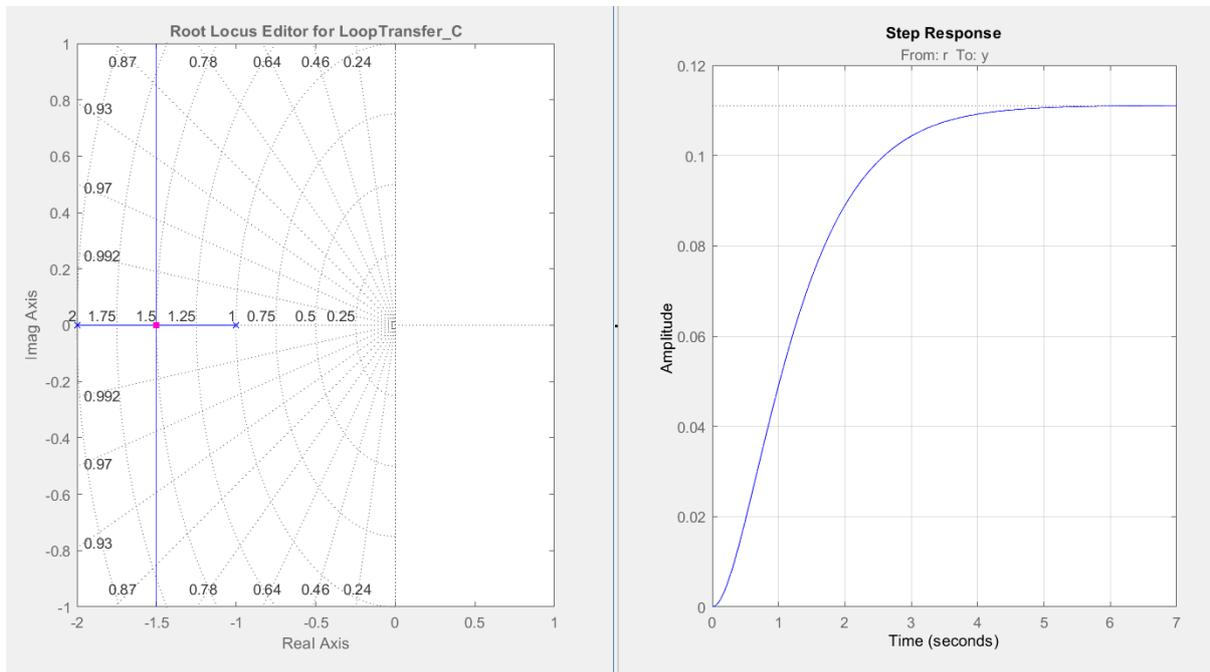
الاستجابة الزمنية عندما تكون نقطة العمل هي نقطة التثنت (الحل المضاعف) (نقطة العمل هي النقطة الحمراء)
