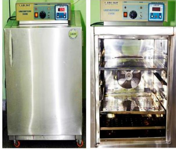
الشكل (1): فرن الهواء الساخن Hot Air Oven.
