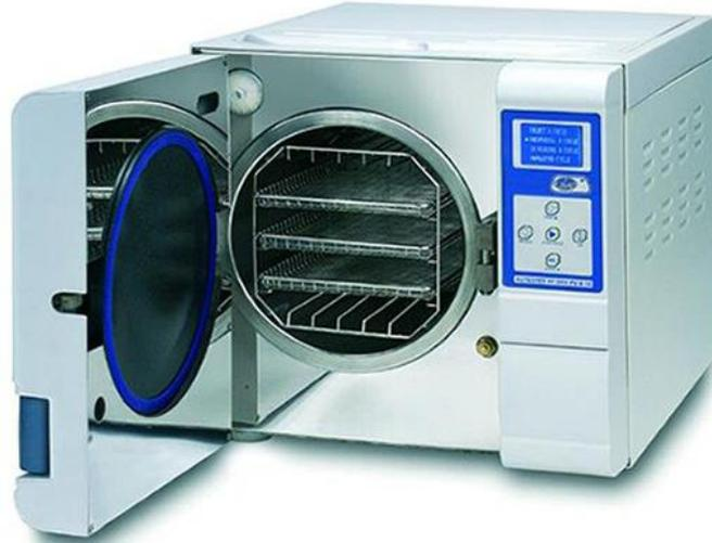
الشكل (2): الصاد الموصد Autoclave.
