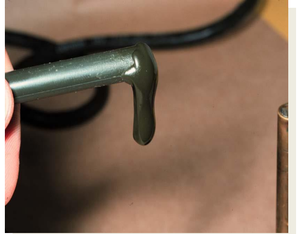
طريقة تليين شمع الكير بواسطة قنديل كحولي
