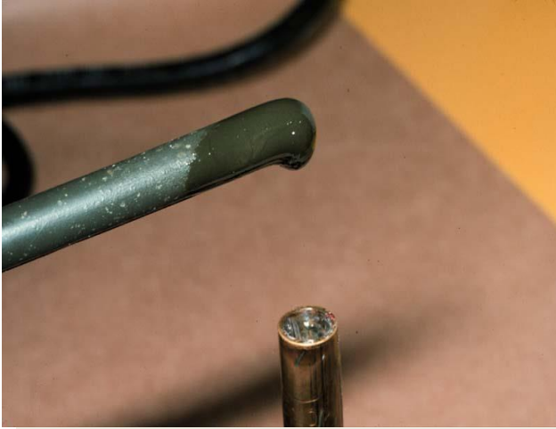
طريقة تليين شمع الكير بواسطة قنديل كحولي
